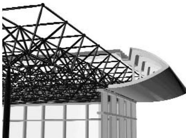
Figura I. 7. Ejemplo de celosía espacial ó estructura estereométrica [F.P.]
