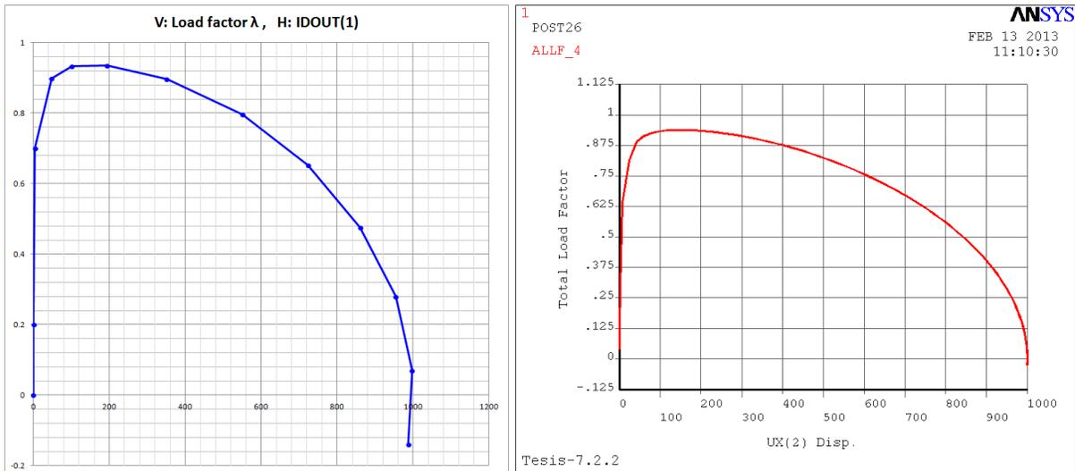
Figura 6. 3. Comparación entre AMBAR y ANSYS, longitud de arco, Despl. horizontal, del ejemplo 5.2.2.
