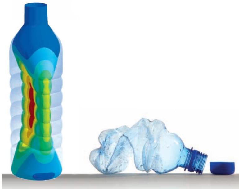
Figura I. 10. Pandeo de una botella plástica. Los lados colapsan por presión interna negativa [6]
