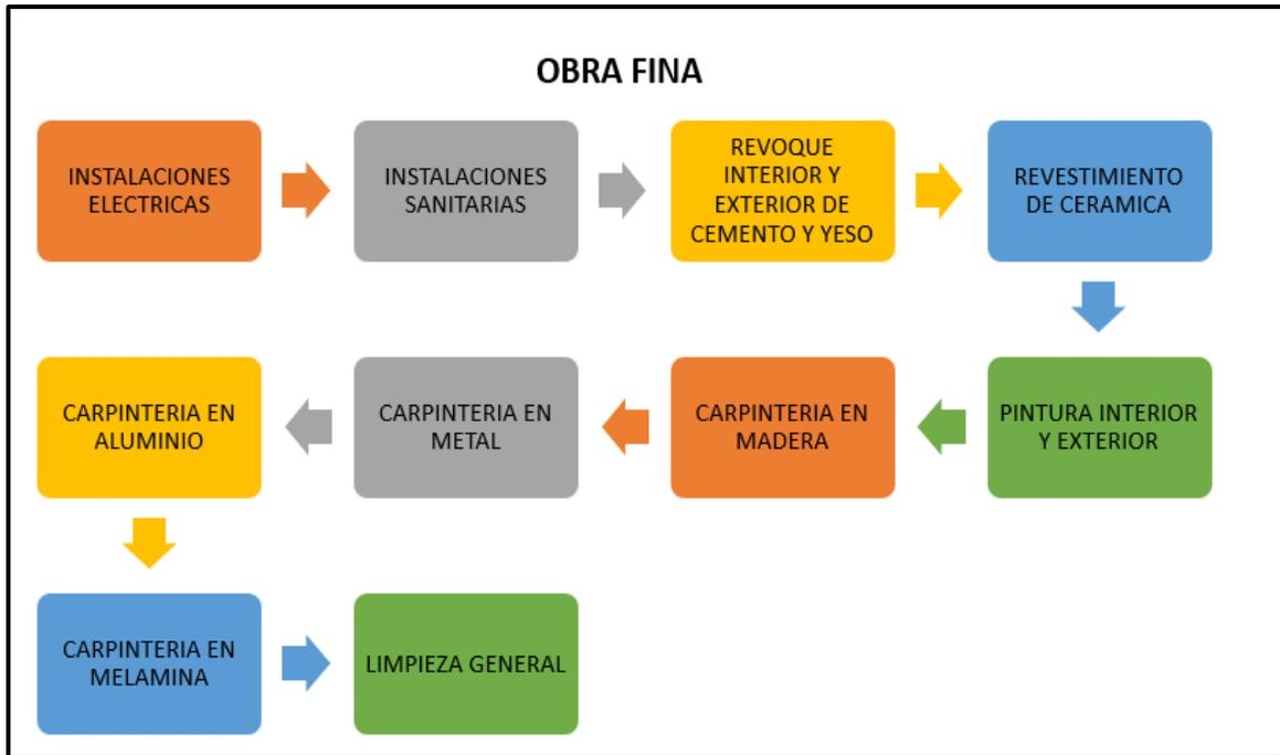
**Nota.** Identificación de las etapas involucradas en la construcción de edificaciones de varios niveles. **Fuente:** Elaboración propia con la colaboración de supervisores de obra de la constructora MAGIS
