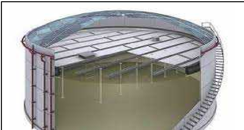
Figura 7. Techo flotante, cubierta externa.
