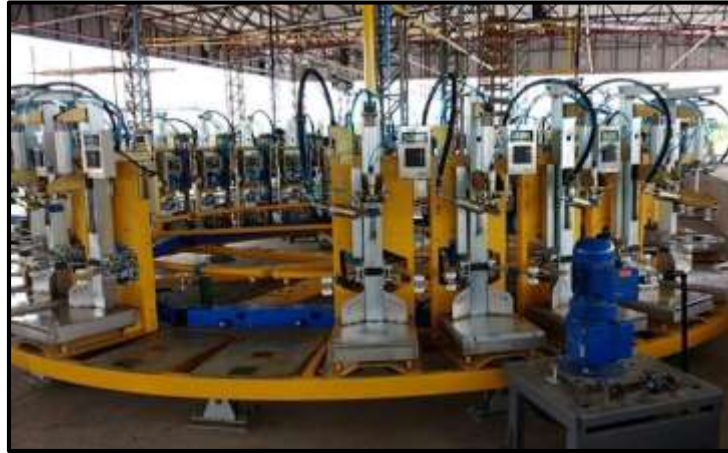
Figura 3: Carrusel con sistema de llenado de GLP
