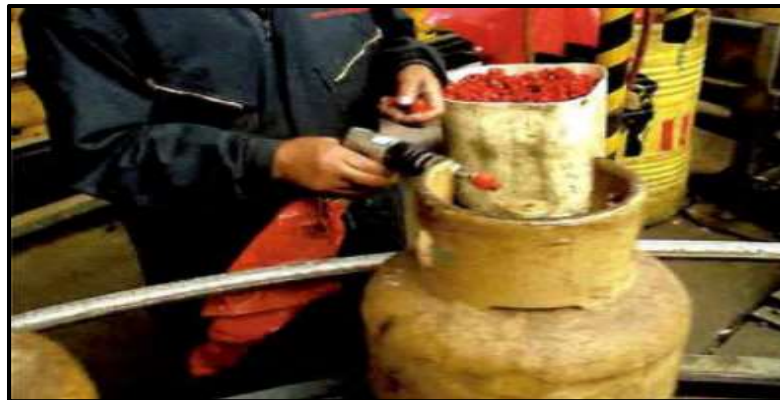
Figura 4: Proceso de taponado de garrafas de GLP con producto
