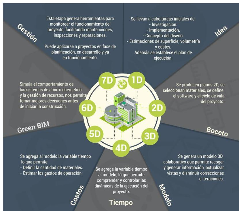
**Figura 1:** Las 7 dimensiones del BIM (Fuente: Espacio Bim).
