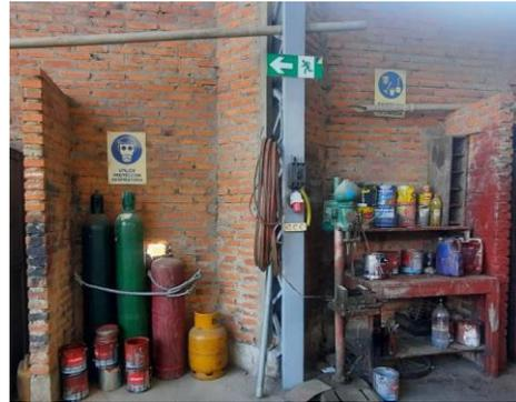
En el taller de soldadura – Maestranza, el trabajo se realiza en un ambiente más abierto, con cruce de aire, el ingreso es estrecho y con gradas, se maneja en su mayoría estructuras metálicas, sin embargo, las herramientas o equipos empleados, pueden ser fuente de peligro. Por ejemplo: compresor de aire para el corte en plasma, oxígeno y gas para realizar soldaduras de emergencia, fragua, entre otros.
