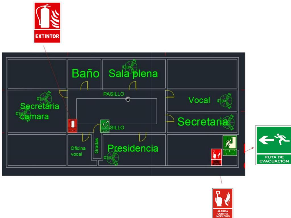
*Figura 13: Diseño de señalización (Tercer Piso)*
