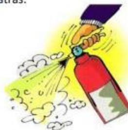
4. Apriete el gatillo mientras mantiene el extintor en posición vertical.
