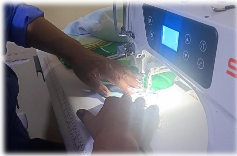
Ilustración 28: Uso de luz led aumentada a la máquina de confección para noche
