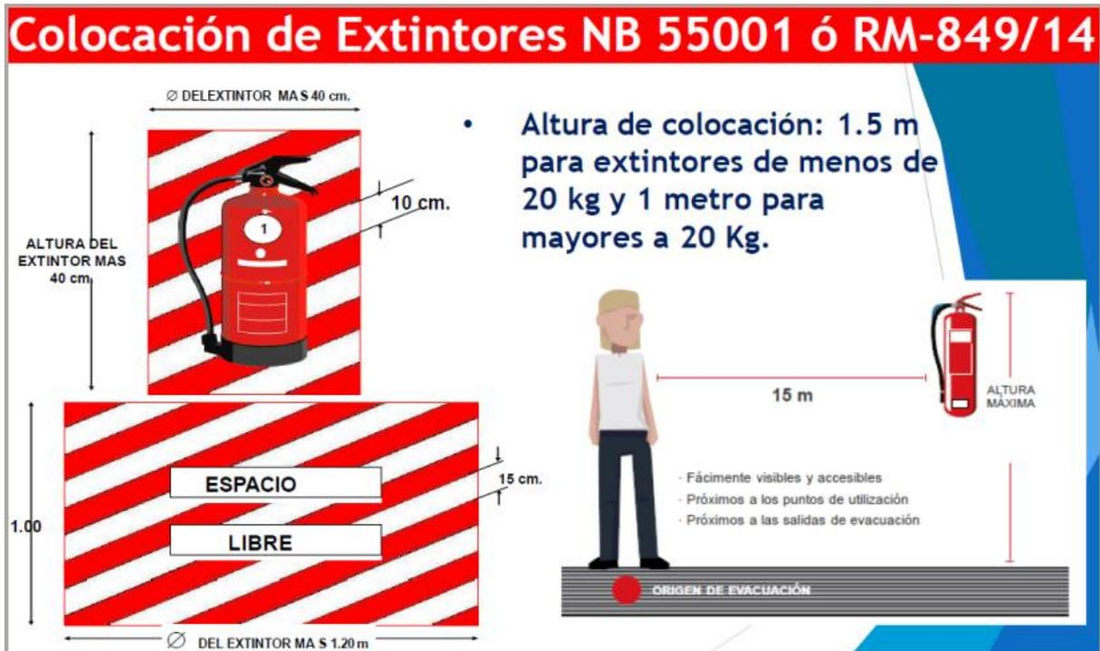
La colocación de los extintores será de a una altura de 1,5 metros del suelo bajo la norma NB 55001 que nos habla sobre la colocación de extintores.
