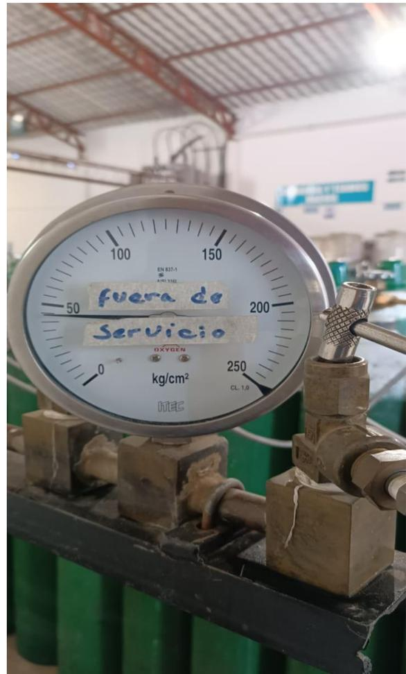
**Anexo 3:** Imágenes donde se observa la acumulación de presión en la línea de distribución al finalizar el llenado de los cilindros (no cuenta con un sistema de despresurización) y la rampa de llenado (no cuenta con un sistema de sujeción para los cilindros).
