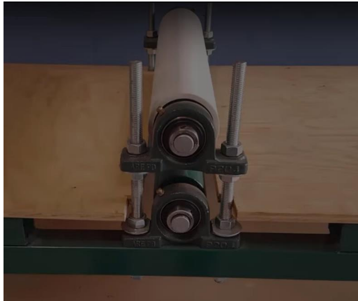
Figura 2-9: Sistema regulador de presión Manual Fuente: EM-INGENIERIA
