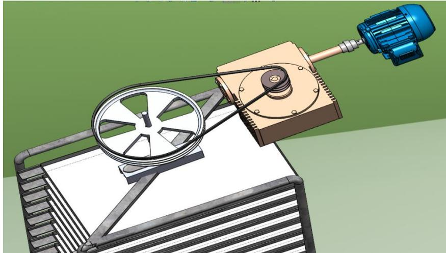
**Figura 2-2:** Configuración típica del sistema rotativo con correa y poleas.
