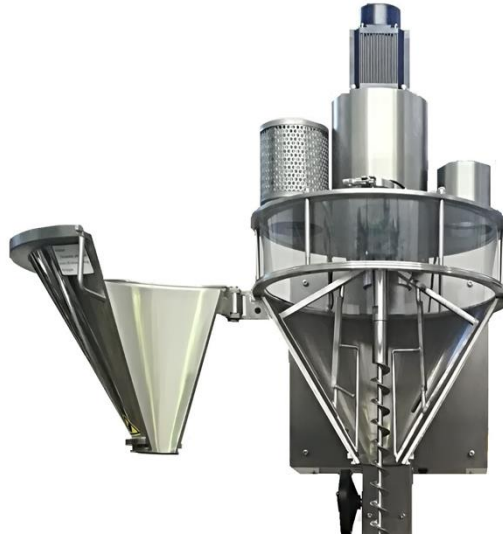
Figura 2-4: Máquina dosificadora de tornillo sin fin Fuente: https://mirpack.es/producto/dosificador-sinfin
