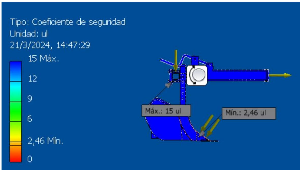
**Figura A6:** Coeficiente de seguridad
