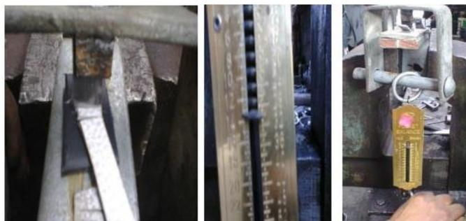
**Figura 2- 13:** Ensayos para calcular la fuerza de corte del cuero
