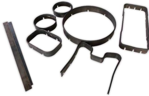
**Figura 2- 10:** Diferentes tipos de cuchillas fabricadas
