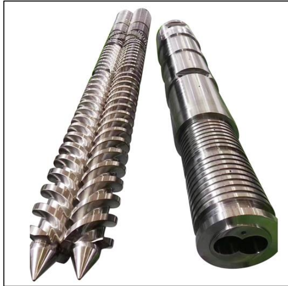
Figura 2-7: Extrusora de doble tornillo Fuente: Superior Machinery
