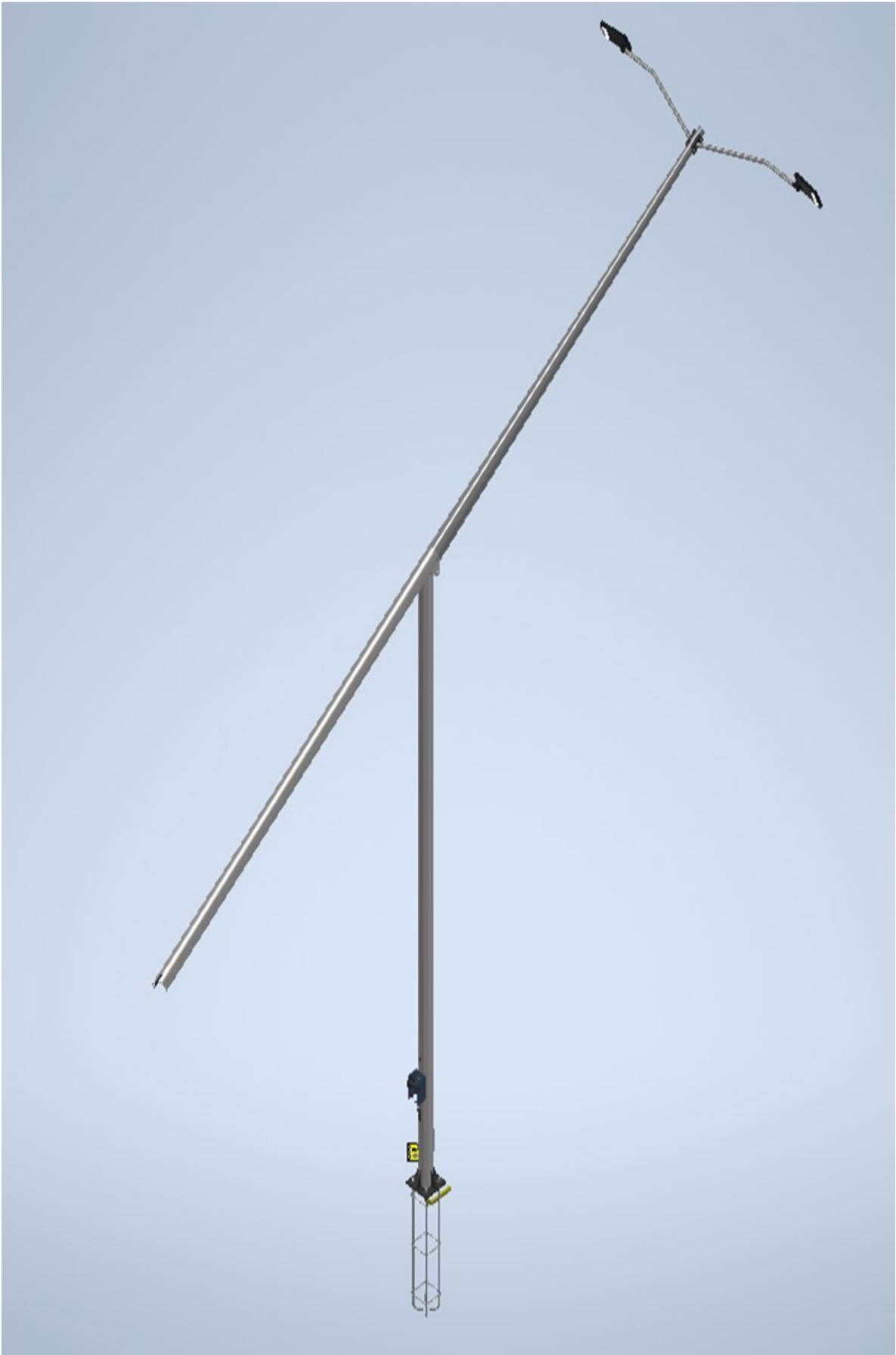
**Figura E-13:** Vista isométrica del poste en posición de abatimiento
