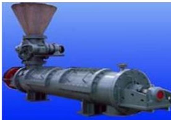
**Figura 2-4:** Granulador de dientes agitado
