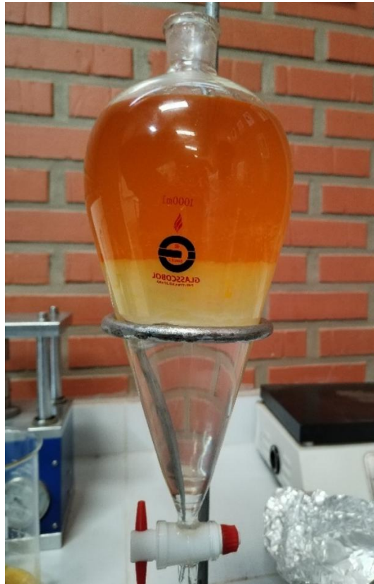
Figura 6. Separación del biodiesel
