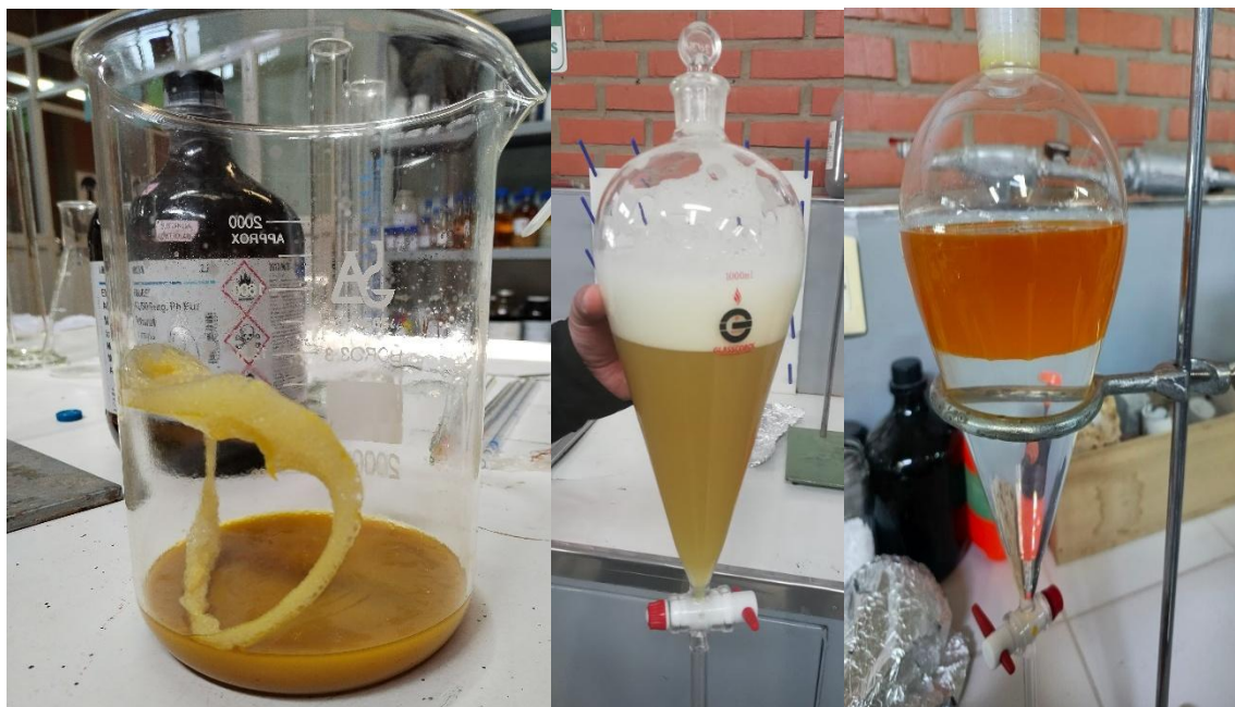
Figura 7. Lavado del biodiesel
