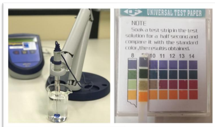
Figura 11. Medición del PH del biodiesel
