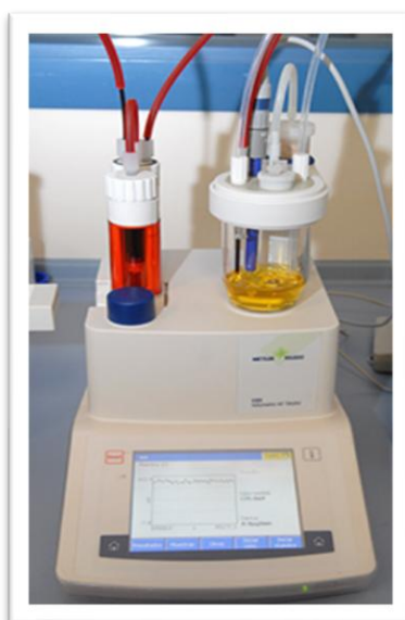
Figura 12. Medición humedad del biodiesel
